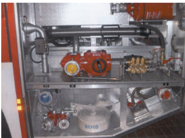
Foto 4: Inbouw van het FireDos -bijmengsysteem in de TLF 24/50
